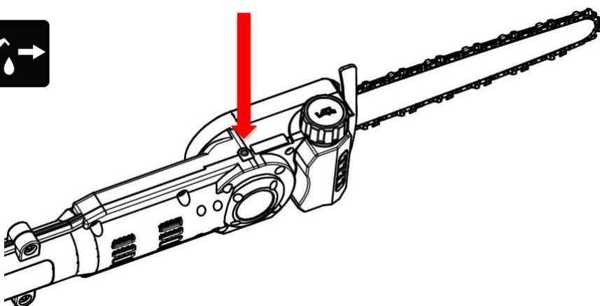
**UTILIZAR MASSA LUBRIFICANTE E ÓLEO DE LÍTIO DE ALTA QUALIDADE PARA GARANTIR A DURABILIDADE E A FIABILIDADE DA FERRAMENTA.**
